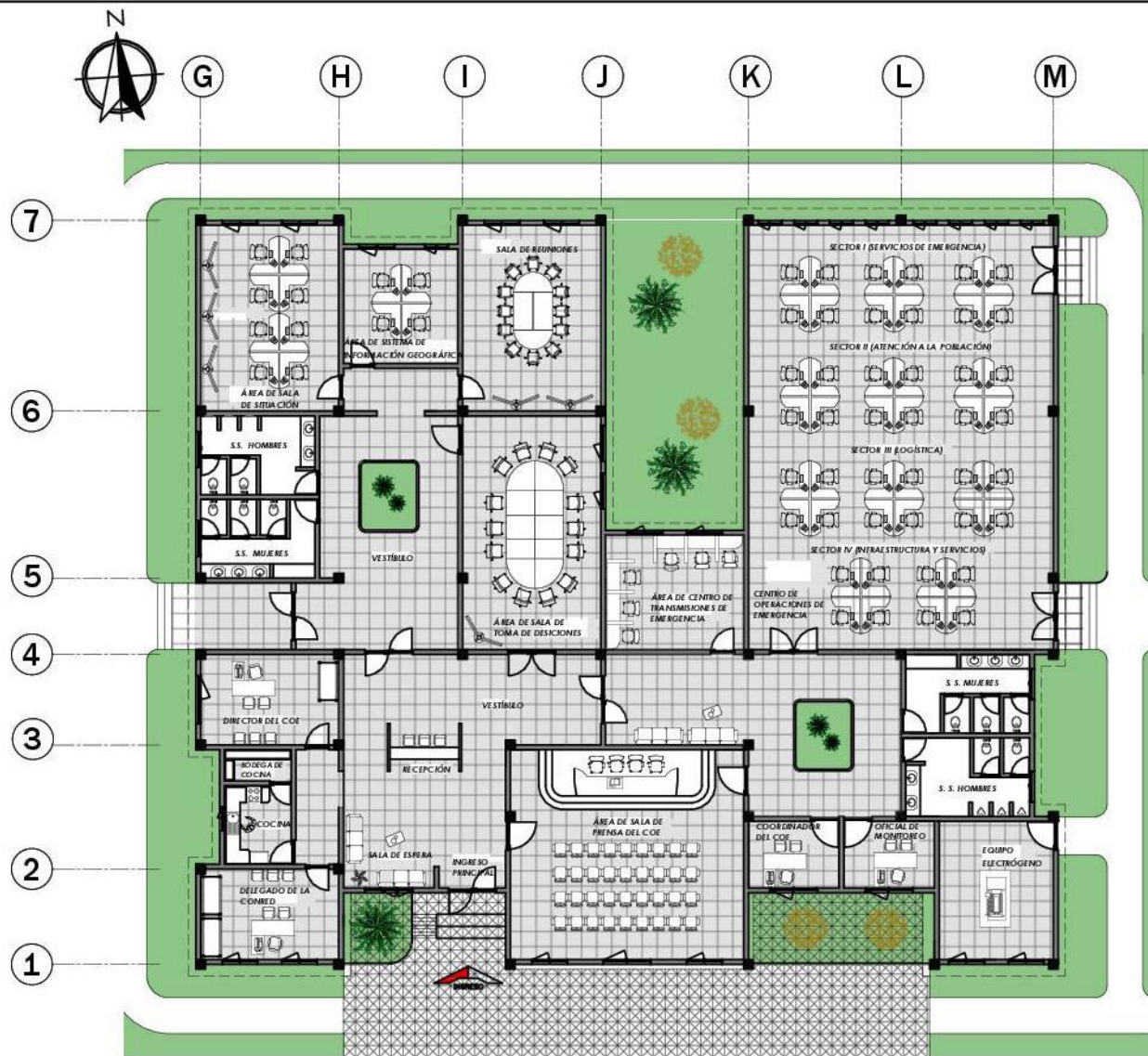
2 Planta Arquitectónica EDIFICIO CENTRO DE OPERACIONES DE EMERGENCIA -COE- ESCALA: 1:200
