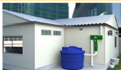
Figura 133: captación de agua
