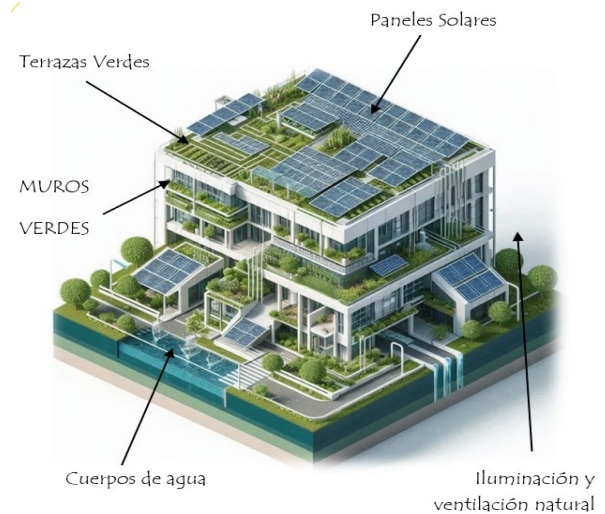
Figura 2. Vista isométrica Arquitectura sostenible. Fuente: elaboración propia
