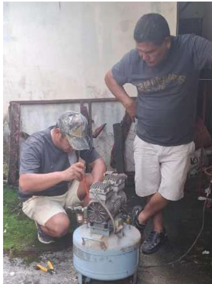
Fotografías No. 23 y 24. Se observa el mantenimiento dado al compresor debido a fallas que había presentado, así también el cambio de espigas y toma corriente para una mejor calidad de uso del equipo dental.
