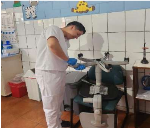
Imagen No.28 y No.29: cambio de rodos al taburete dental del operador.
