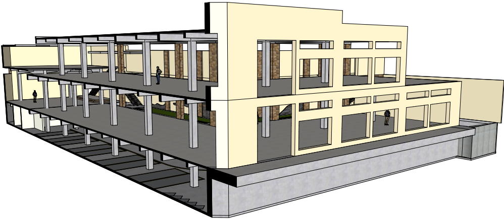
PERSPECTIVA DE MARCOS RÍGIDOS Y LOSAS TRADICIONALES.
