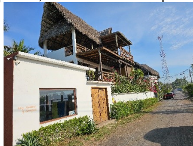
La arquitectura de los nuevos desarrollos de albergues para al turismo suelen ser de varios niveles, con estructura de concreto y block de pómez, recubrimiento blanqueado y con cubierta final de palma.
