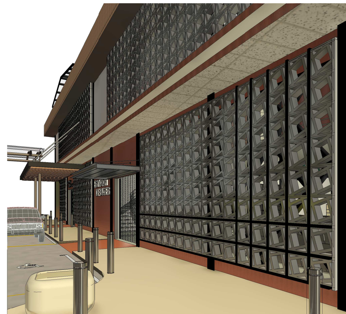
DETALLE DOBLE PIEL PARTE LUCES
