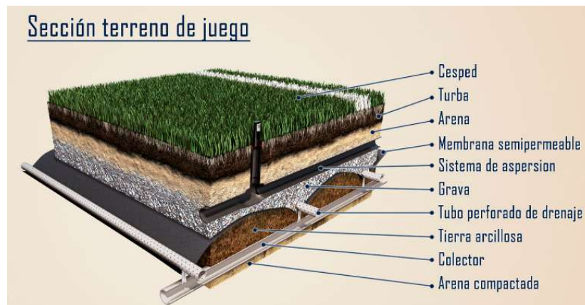
Ilustración 11. Función de drenaje de campo de juego Fuente: https://arpasa.es/es/futbol/drenaje-cesped-campo-futbol/
