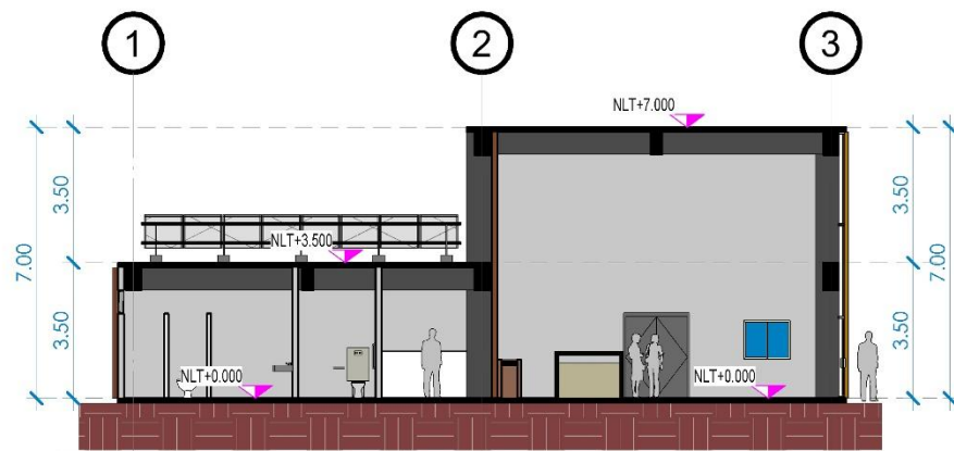
S1 SECCIÓN LONGITUDINAL
