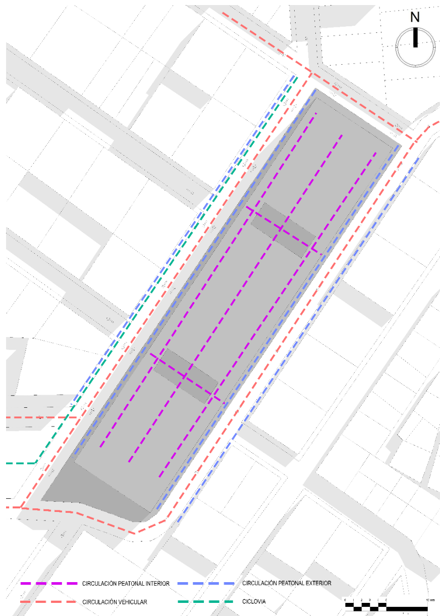
Figura 107. Planta de circulaciones. Fuente: Elaboración propia
