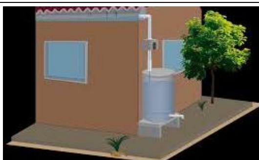
Figura 82. Sistema captación agua pluvial
