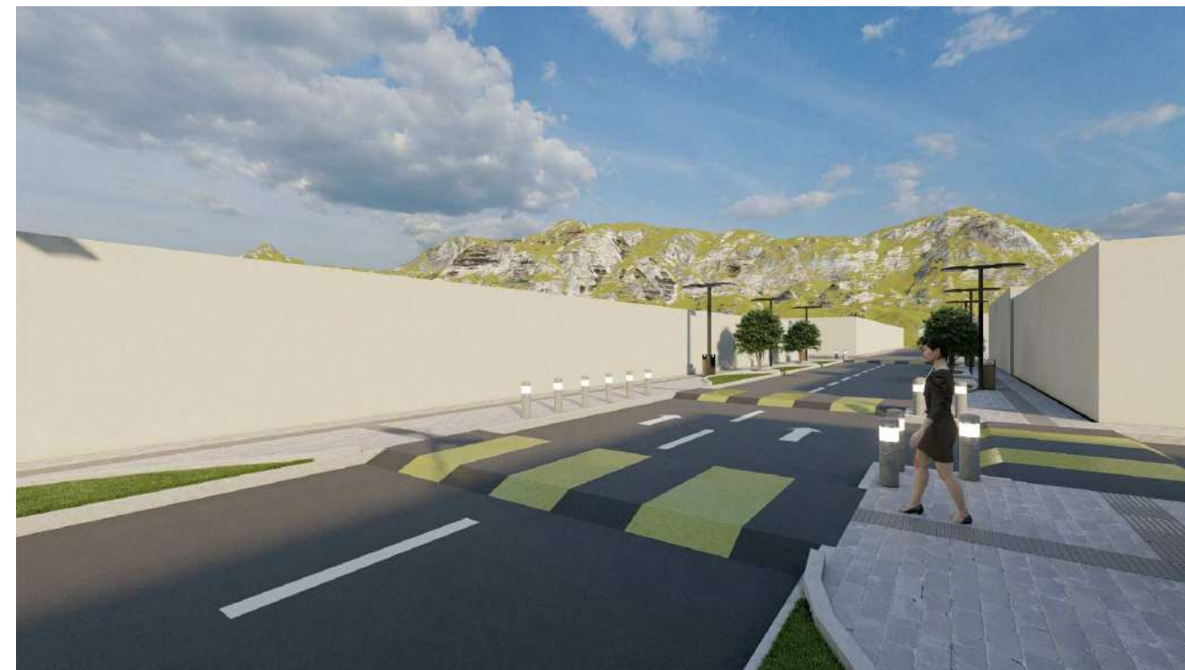
VISTA INGRESO A INSTITUTO/ REDUCTORES DE VELOCIDAD Y BOLARDOS
