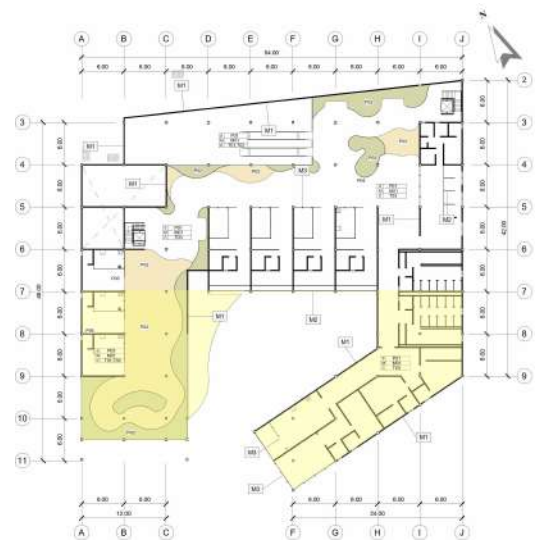
2 Planta acabados general nivel 2 terminal Sin Escala
