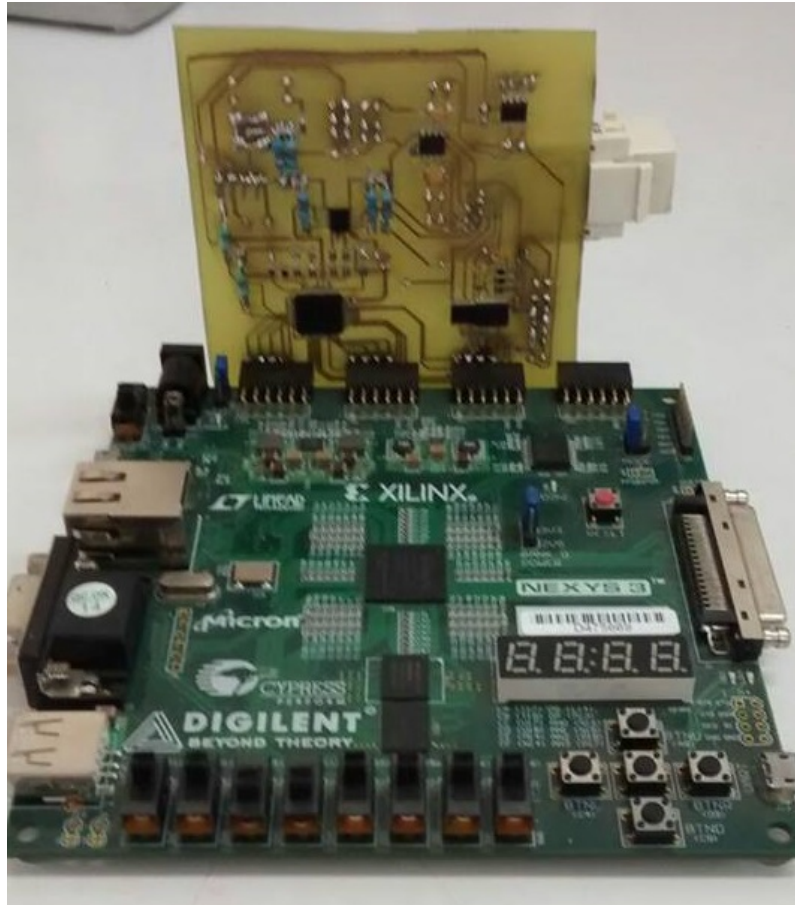
Figura 23. Implementación del prototipo núm. 1 en PCB
