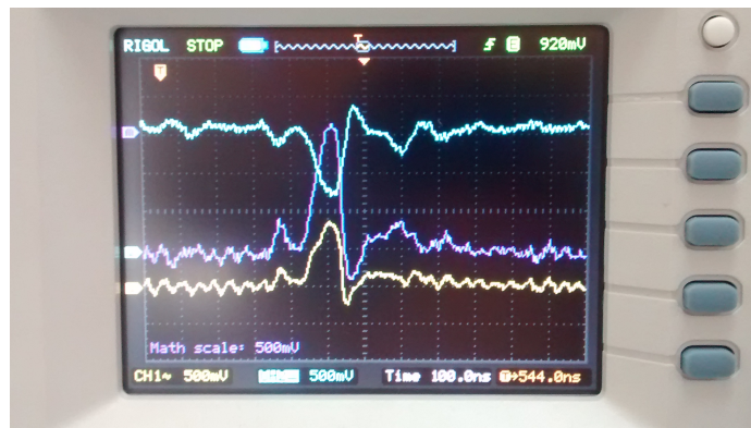
Figura 29. Salida diferencial despues de las modificaciones
