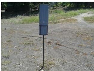
Figura 17. Pluviómetro ubicado en finca Ojo de Agua
