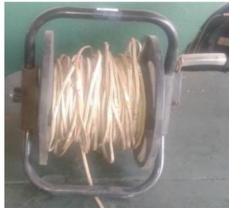
Figura 15. Sonda utilizada para la medición de niveles de pozos
