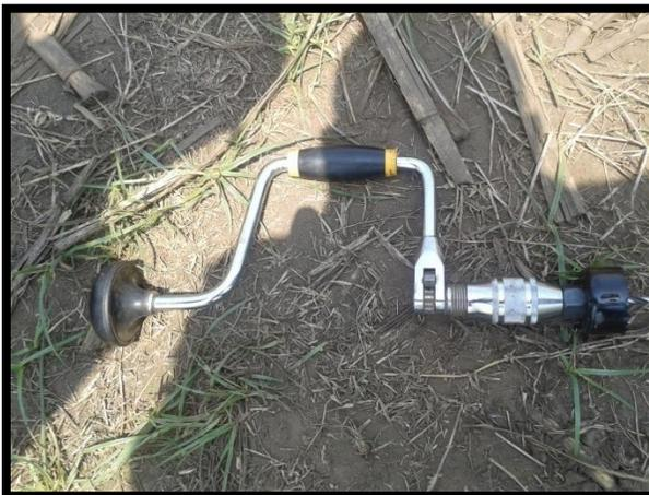
Figura 65. Trepano para abrir tuberías
