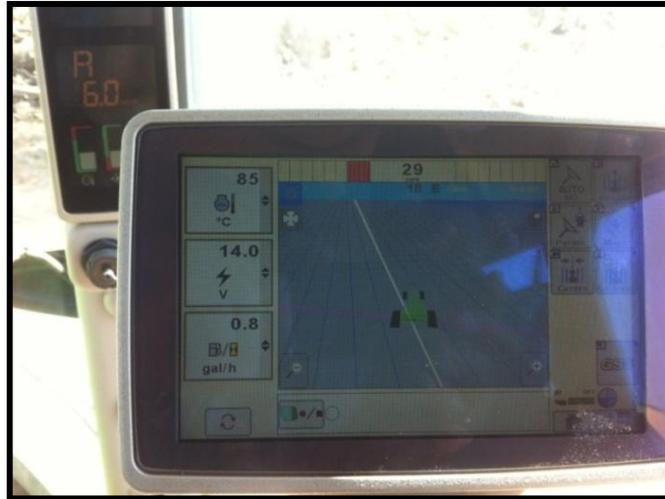
**Figura 50.** Panel del sistema RTK del tractor.
