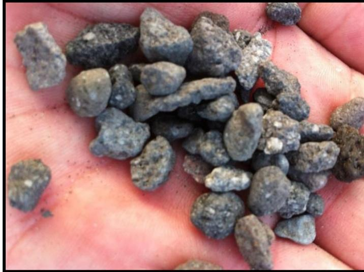
**Figura 27.** Grava para filtración de pozo.
