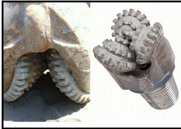
**Figura 22.** Broca tricono para perforación de pozos.
