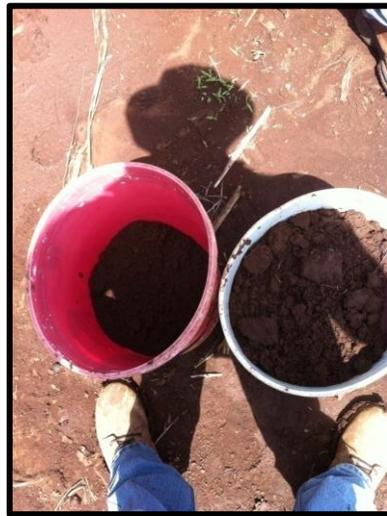
**Figura 71.** Homogenización de la muestra con dos cubetas.
