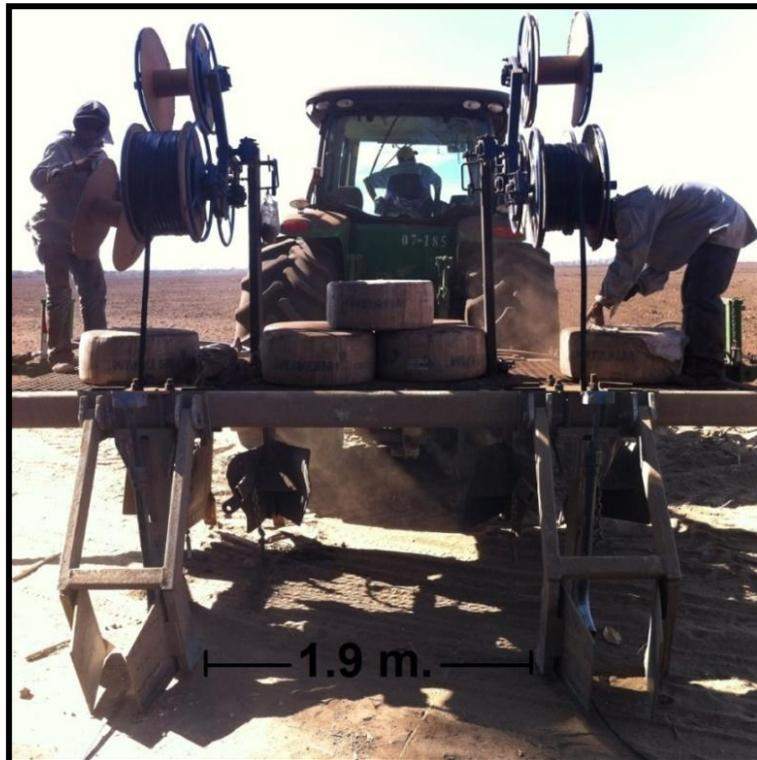
**Figura 47.** Implemento para inyección de manguera.
