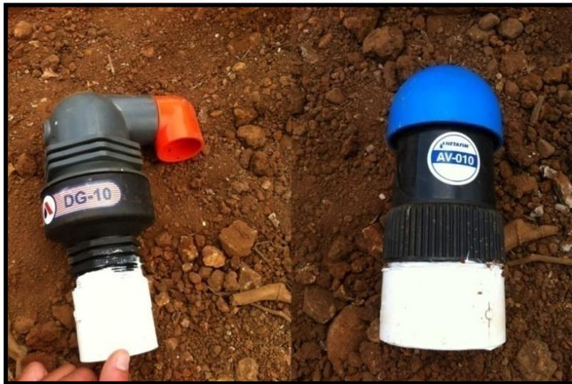
**Figura 57.** Válvulas de presión y aire para aliviar presiones.
