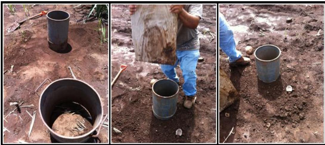
**Figura 73.** Ingreso del cilindro interno en el perfil del suelo.
