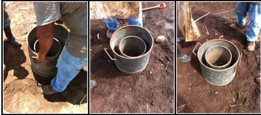
**Figura 74.** Ingreso del cilindro externo en el perfil del suelo.
