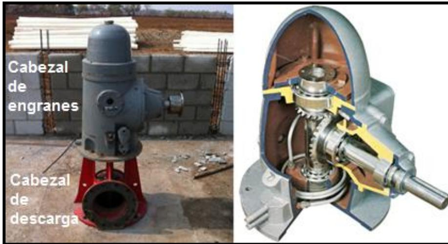
**Figura 31.** Cabezal de engrane y de descarga instalados.
