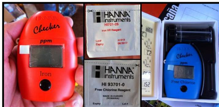
**Figura 82.** Medidor portátil de partes por millón para hierro y cloro libre.
