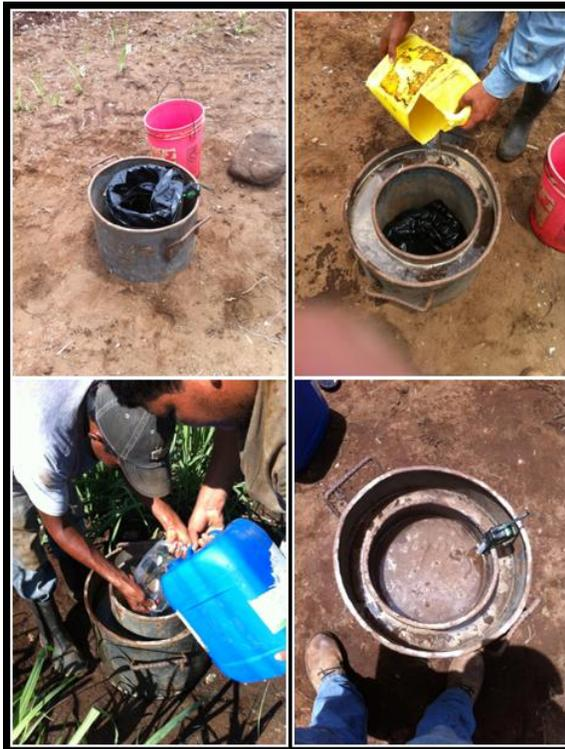
**Figura 75.** Llenado del cilindro los cilindros con ayuda de un recipiente.
