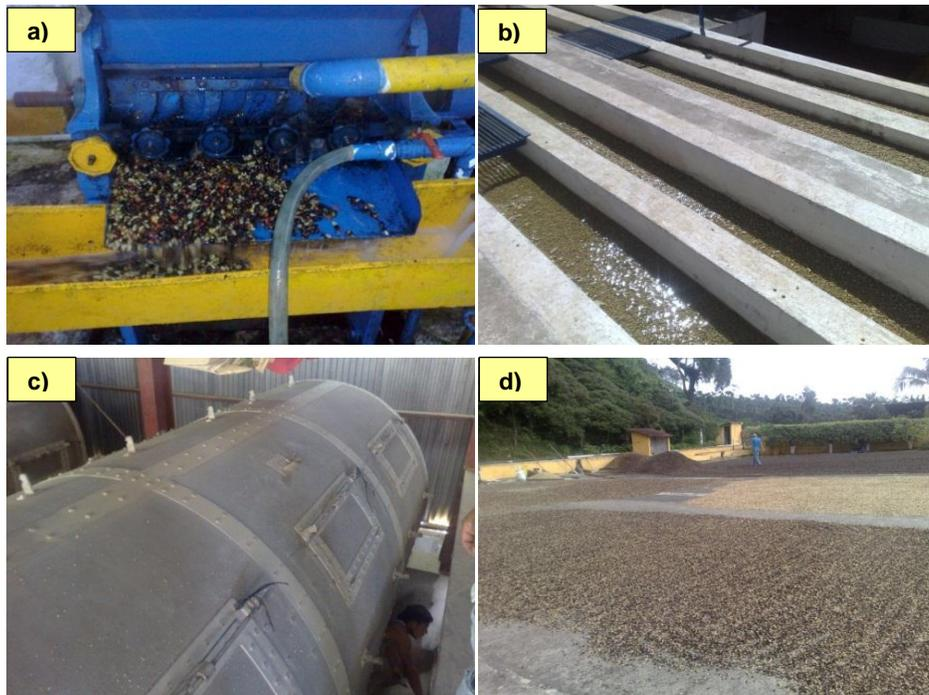
Figura 17. Beneficiado del café en finca Las Nubes. a) Despulpador, b) Pilas de fermentación de café, c) Secadora de café tipo guardiola, e) Patios de secado.
