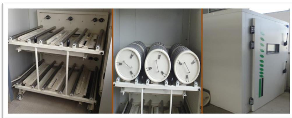
Figura 15. Colocación de cilindros dentro de la cámara secadora.
