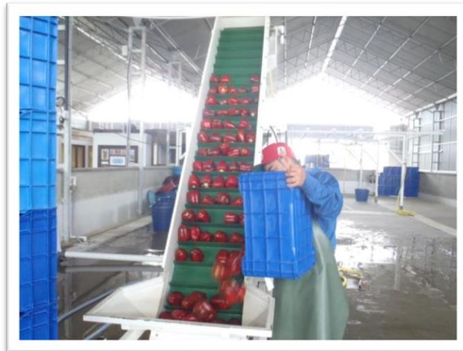
Figura 6. Distribución de los frutos en la banda transportadora de la máquina extractora de semillas.
