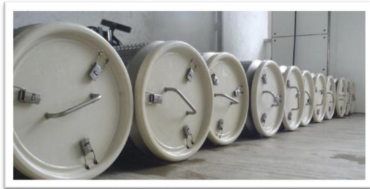
Figura 13. Cilindros utilizados en la extracción del exceso de agua de las semillas.
