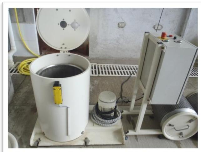
Figura 14. Centrifuga utilizada para la extracción del exceso de agua.
