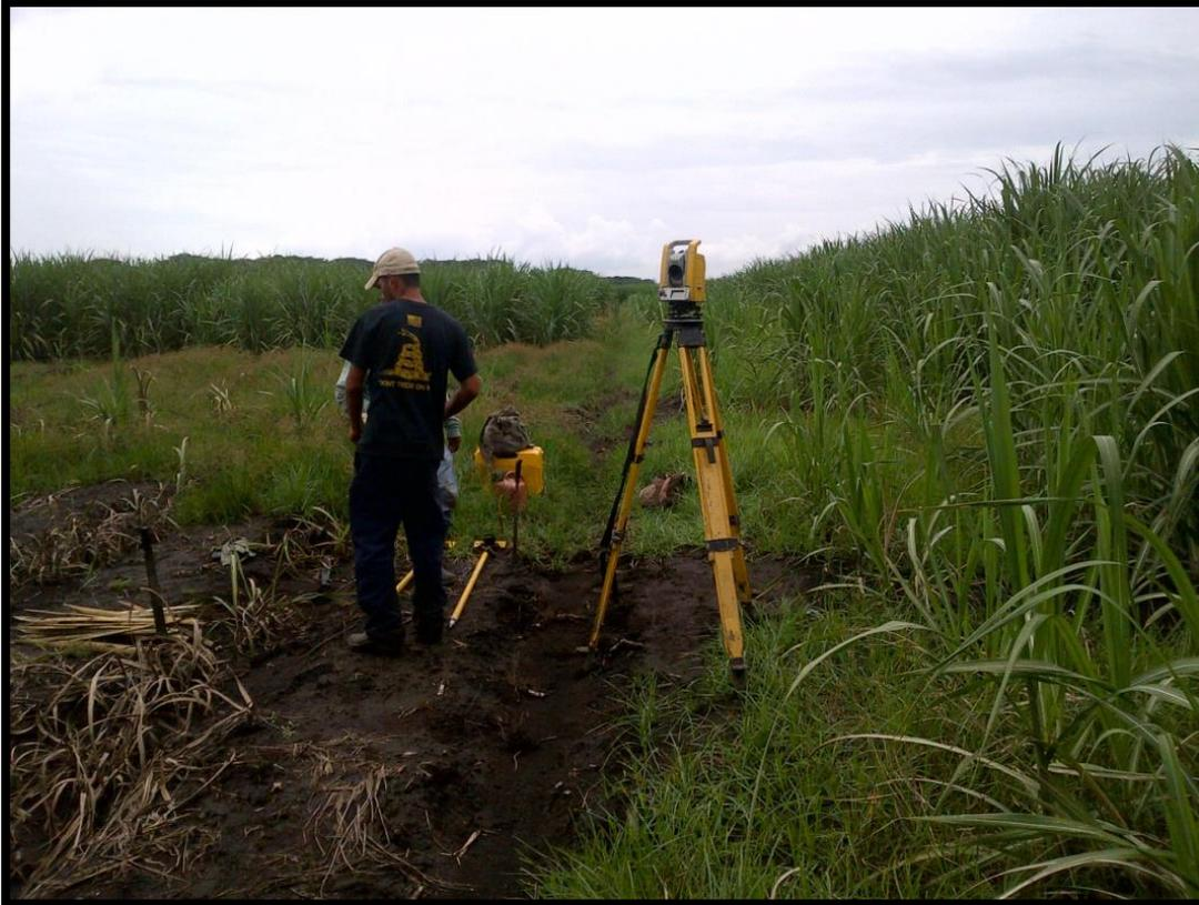
**Figura 28. Trazo de parcelas con estación total dentro de las áreas experimentales.**
