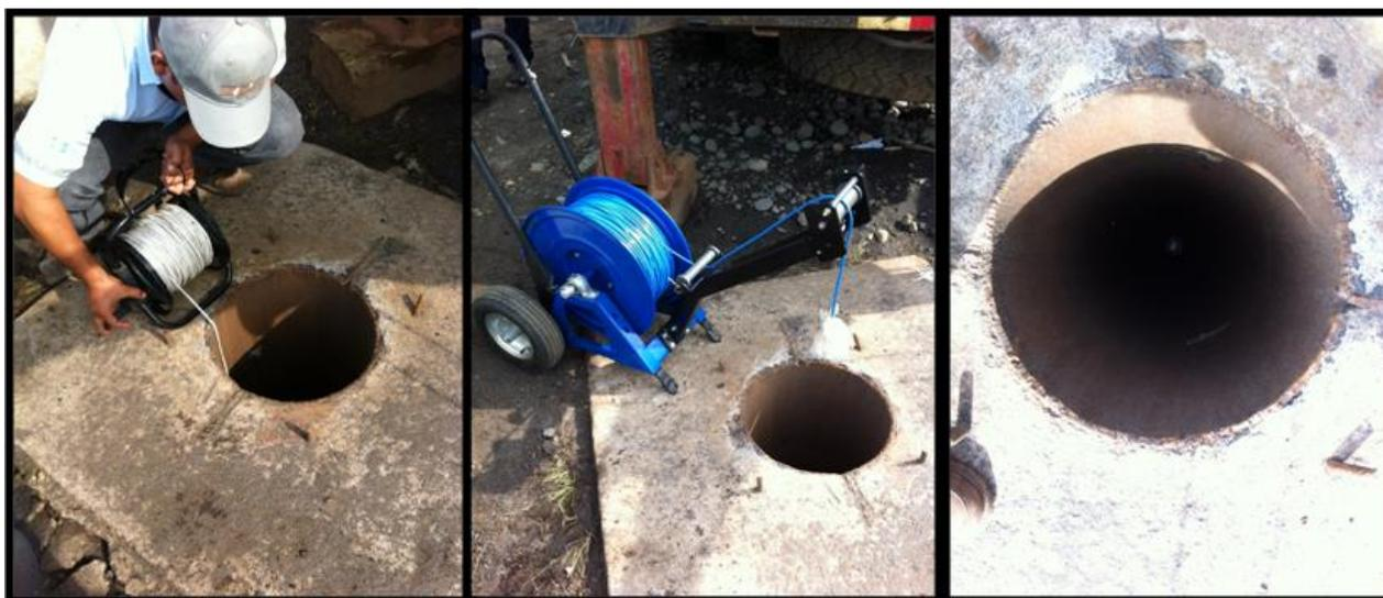
**Figura 48. Sondeo de pozos con nivel piezométrico y sonda de exploración.**
