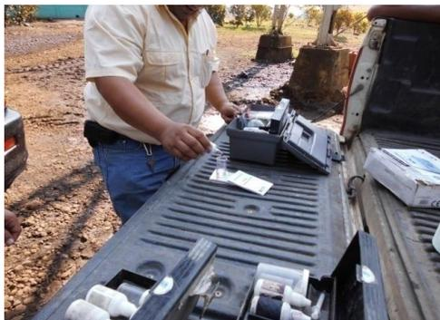
Figura 46A. Aplicación de solución buffer a la muestra de agua.
