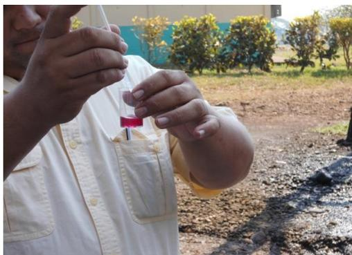
Figura 48A. Titulación de muestra con corrector de dureza.
