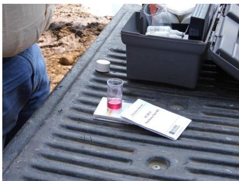
Figura 47A. Coloración de la muestra ya aplicado el indicador.
