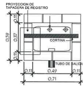
DETALLE TRAMPA DE GRASA (PILA)
