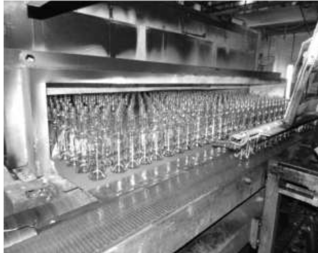
Figura 15. Tratamiento de templado, área caliente
