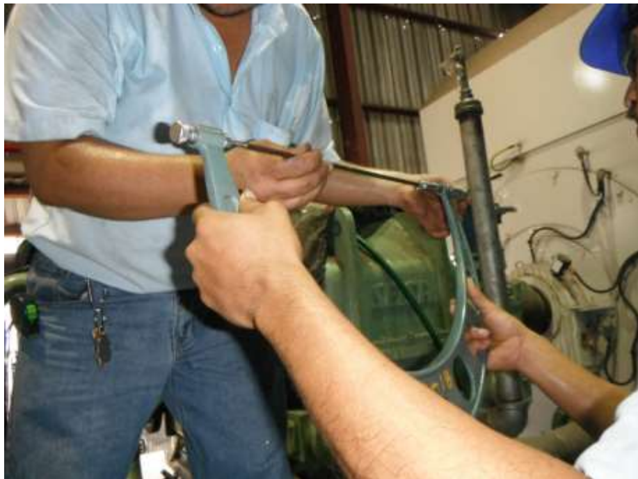
Figura 22. Varilla calibrada y micrómetro para interiores
