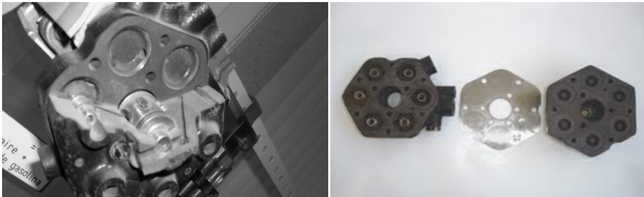
Figura 6. Distribuidor de combustible
