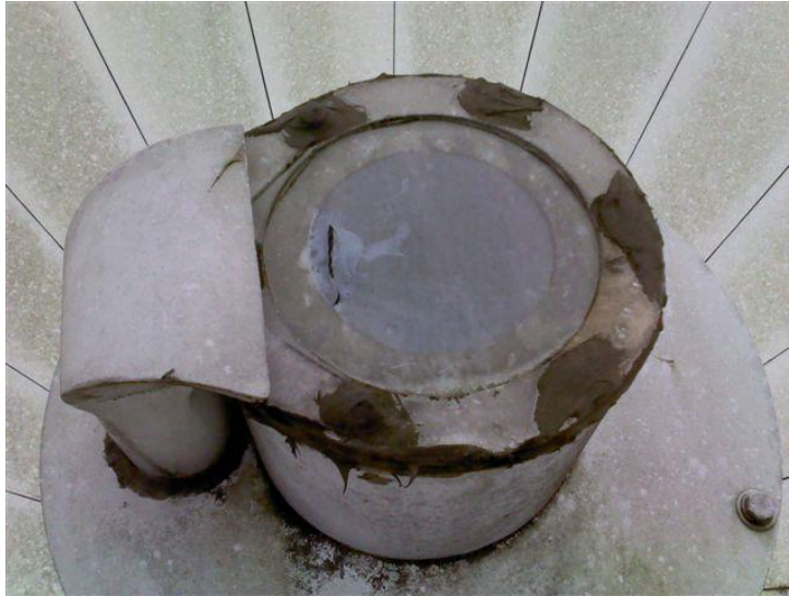
Figura 23. Membrana rota por un ave
