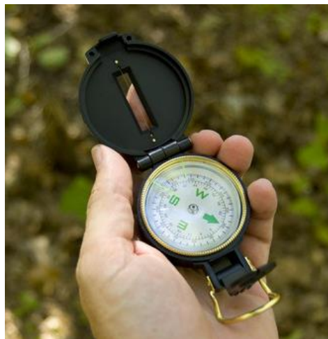
Figura 18. Brújula para determinación del ángulo de azimut
