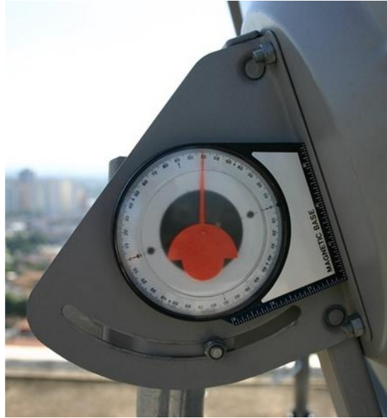
Figura 20. Inclinómetro para determinación del ángulo de elevación
