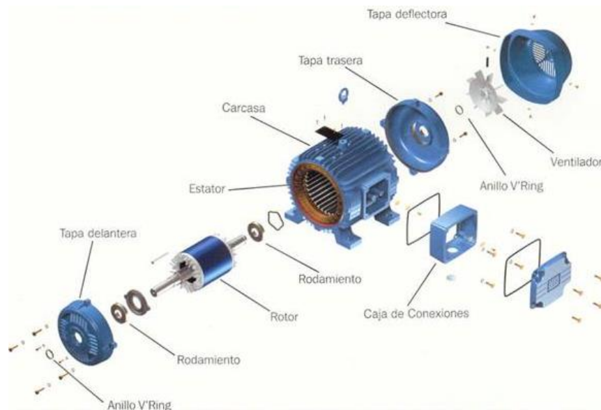
Figura 26. Constitución de un motor eléctrico trifásico
