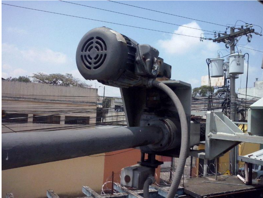
Figura 17. Motor para movimiento en azimut
