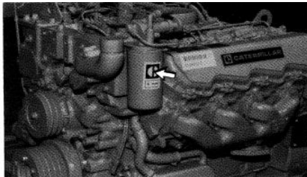
Figura 19. Filtro de combustible
