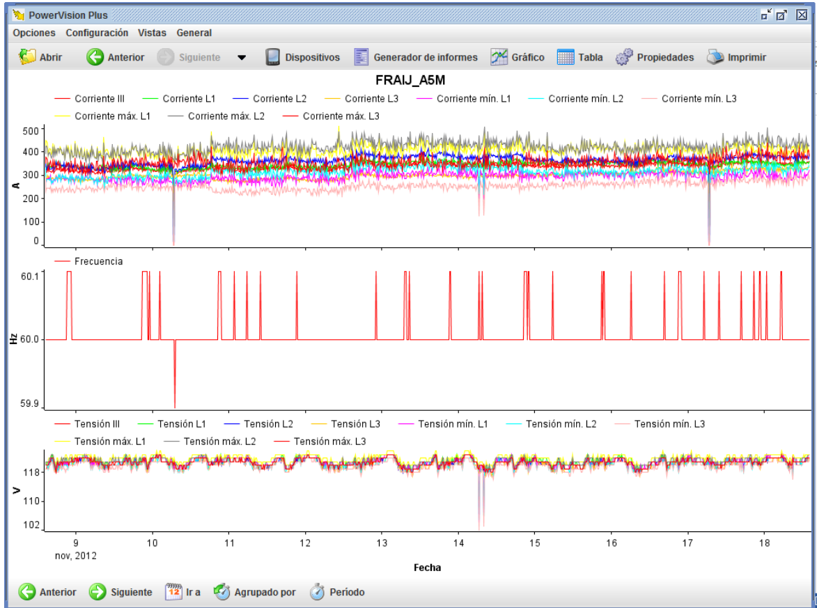
Figura 22. Gráfico de corriente, frecuencia y voltaje (Granja Penal de Pavón, Fraijanes)
