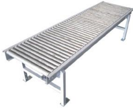
Figura 18. Transportadora de rodillos sin transmisión
