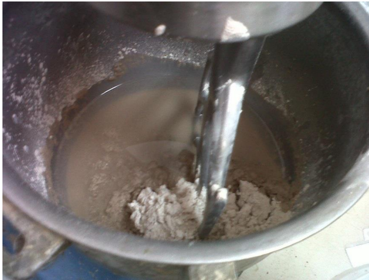
Figura 34. Mezclado del material en la mezcladora
