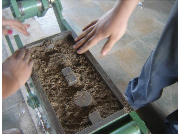
Figura 46. Acomodo del material dentro del molde de la prensa manual
