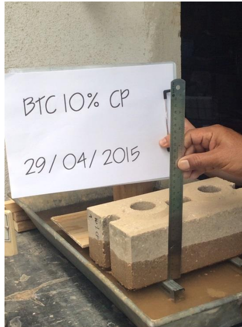
Figura 61. Ensayo de absorción de agua por capilaridad
