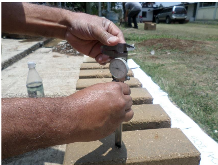
Figura 59. Medida de las oquedades, ensayo de erosión acelerada Swinburne (SAET)
