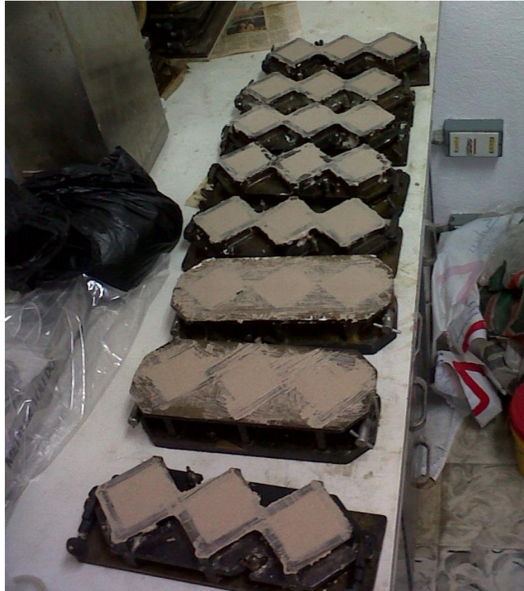
Figura 36. Moldes llenos con la mezcla
