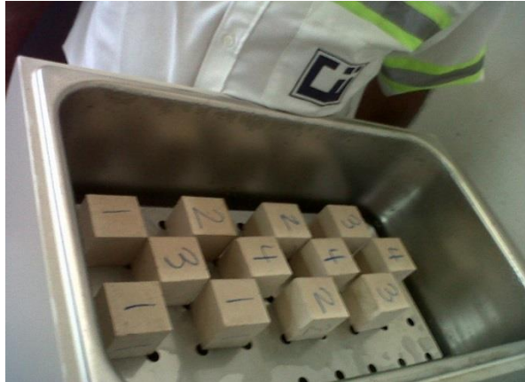
Figura 37. Curado a vapor
