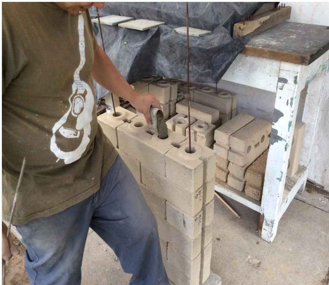
Figura 5. Fundición de pines y llaves de los BTC en el levantado del prisma
