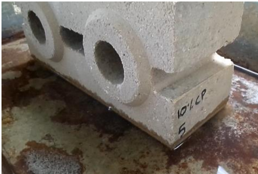
Figura 55. Ensayo de humectación/secado de un BTC estabilizado con 10 % de aglomerante natural cal puzolana
