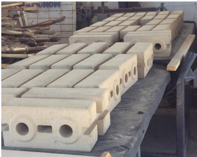
Figura 51. Secado al ambiente de los BTC estabilizados con cemento tipo UGC
