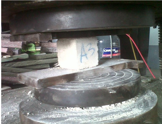
Figura 41. Ensayo a compresión en la máquina universal
