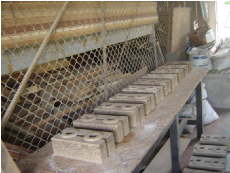
Figura 49. Colocación de los BTC en una superficie plana
