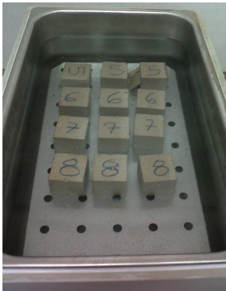
Figura 38. Curado en inmersión en agua a 80 °C
