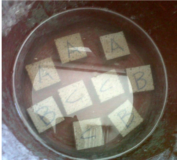
Figura 40. Curado en agua a temperatura ambiente
