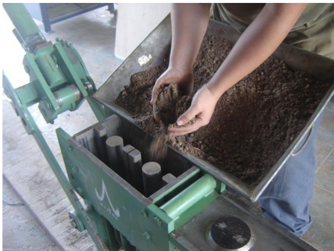
Figura 45. Colocación del material dentro del molde de la prensa manual
