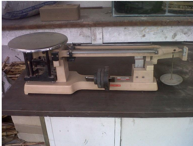
Figura 16. Balanza de precisión Heavy Duty, marca Ohaus, 20 kg de capacidad y 0,1 g de precisión
