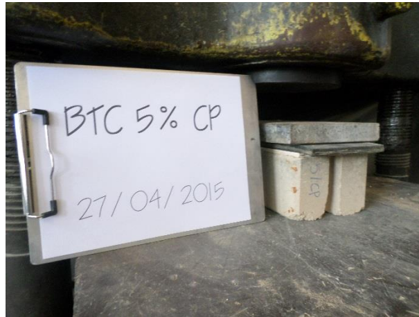
Figura 53. Ensayo a compresión de un BTC estabilizado con 5 % de aglomerante natural cal puzolana
