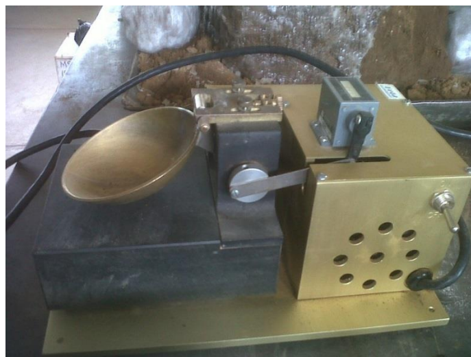
Figura 12. Copa de Casagrande, marca Humboldt H-4226
