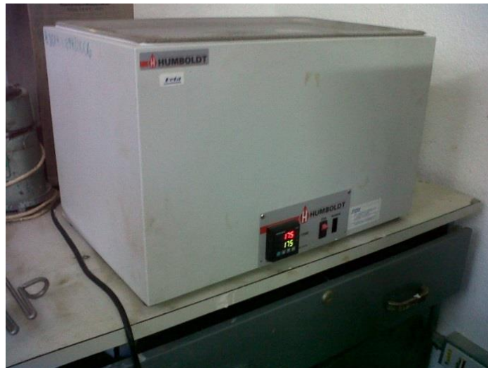
Figura 10. Cámara de curado acelerado, marca Humboldt H 1390
