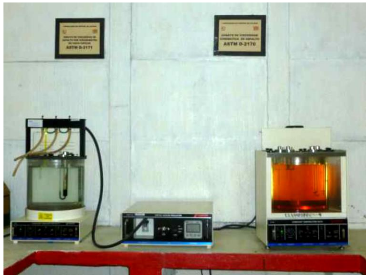
Figura 41. Equipo de ensayo para viscosidad Saybolt-Furol
