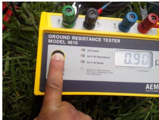
Figura 24. Resistencia del suelo, medida a un costado del cuarto del tablero principal
