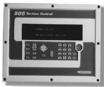
Figura 39. Microprocesador 505 para el control digital de la turbina Worthington
