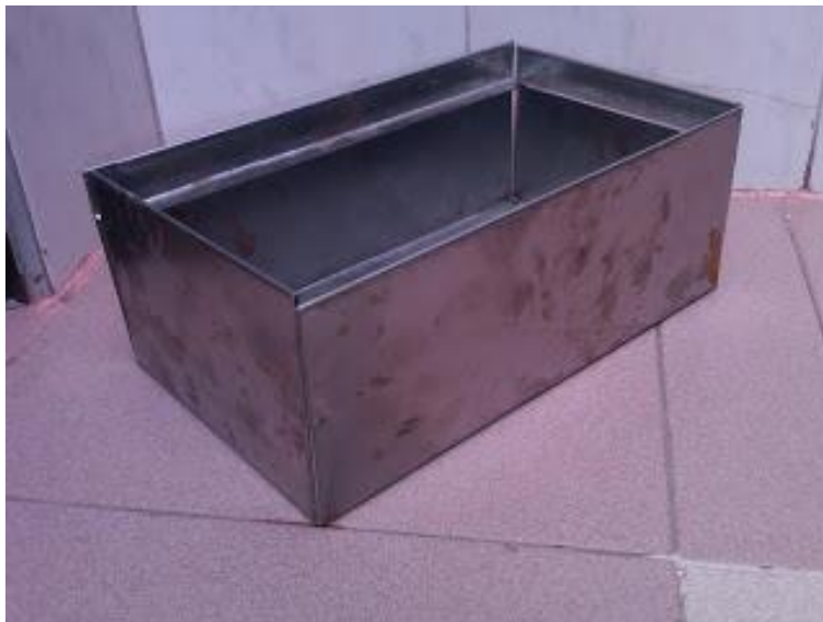
Figura 17. Lámina de acero al carbón doblada para guarda
