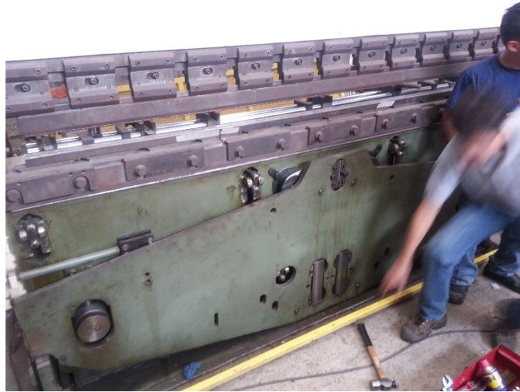
Figura 41. Dobladora de lámina sin protector
