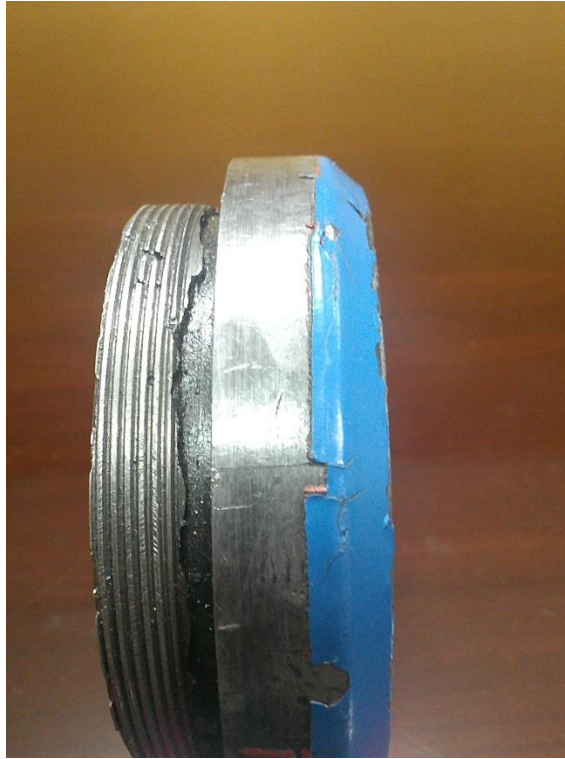
Figura 26. Tapa contra la suciedad del husillo dañada
