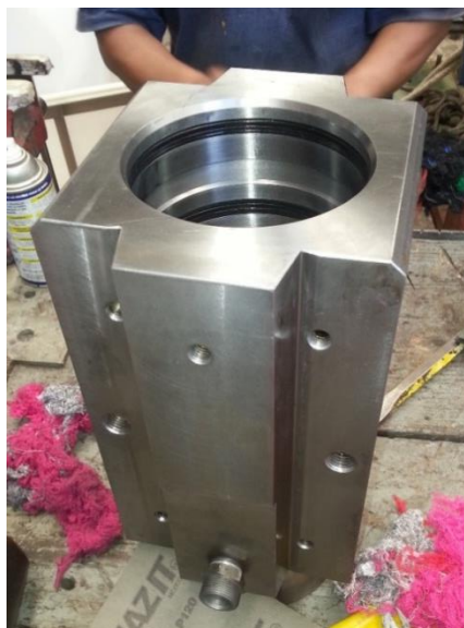
Figura 45. Motor hidráulico con o-rings nuevos
