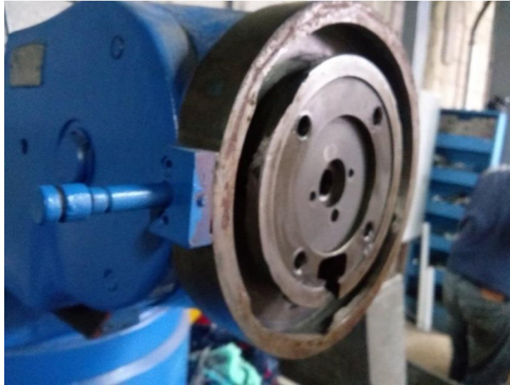
Figura 28. Adaptador en mal estado
