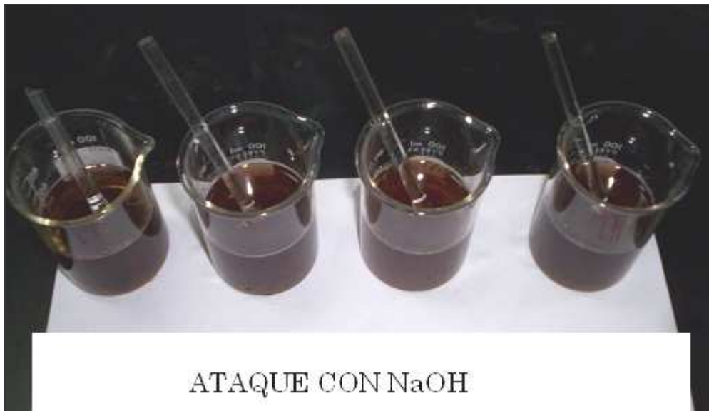
Figura 27 Determinación de \alpha -Celulosa, ataque con NaOH
