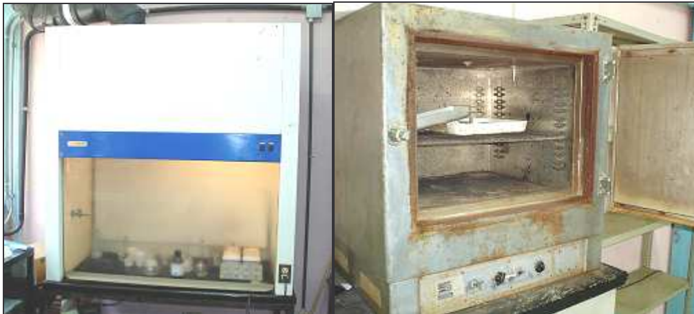
Fig.12 Equipo 3. Campana de extracción de vapores y horno eléctrico con recirculación
