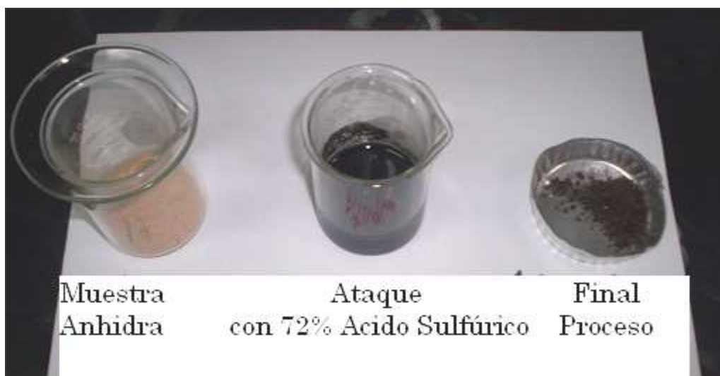
Figura 26 Secuencia en la determinación de Lignina en madera de Pino ocote
