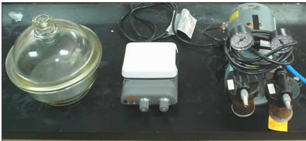
Fig.10 Equipo 1. Desecadora, Plancha de calentamiento y agitación; y bomba de vacío
