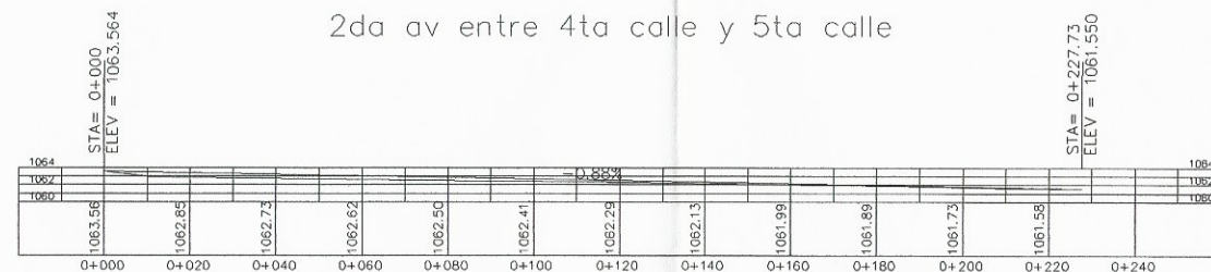
PERFIL ESCALA HORIZONTAL 1/1000 ESCALA VERTICAL 1/500
