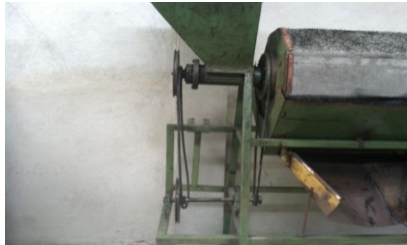
Figura 3. Vista frontal de correas de transmisión de potencia
