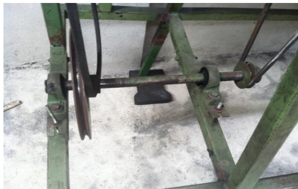
Figura 5. Sistema de poleas inferiores
