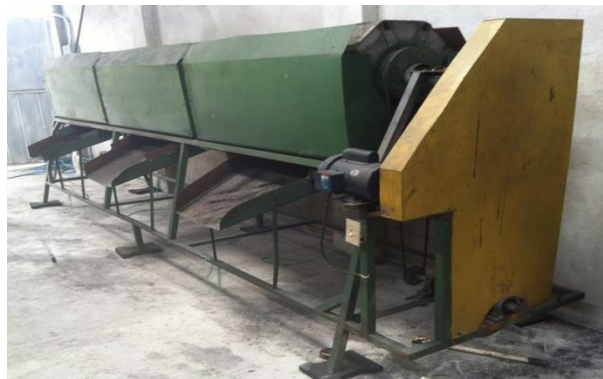
Figura 22. Vista de criba rotativa de clasificación final
