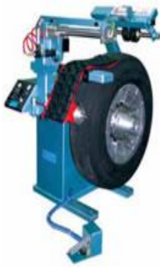
Figura 62. Maquinaria utilizada para raspado de llantas
