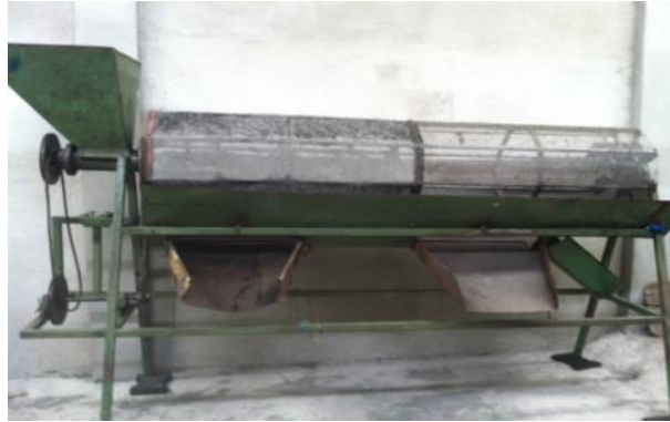
Figura 1. Vista frontal de criba rotativa de clasificación inicial
