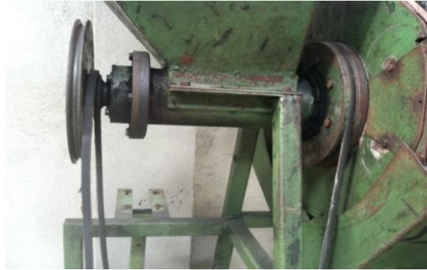
Figura 4. Sistema superior de poleas
