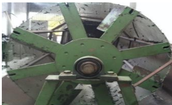
Figura 2. Vista de chumacera en estación 1
