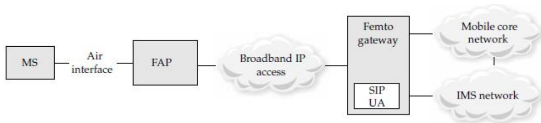
Figura 14. Arquitectura red IMS con Femto celdas
