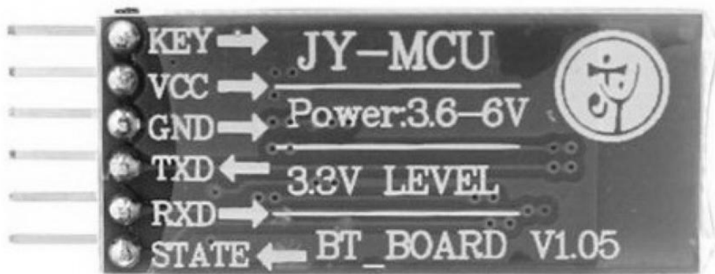
Figura 13. Pines de conexión para módulo Bluetooth HC-05
