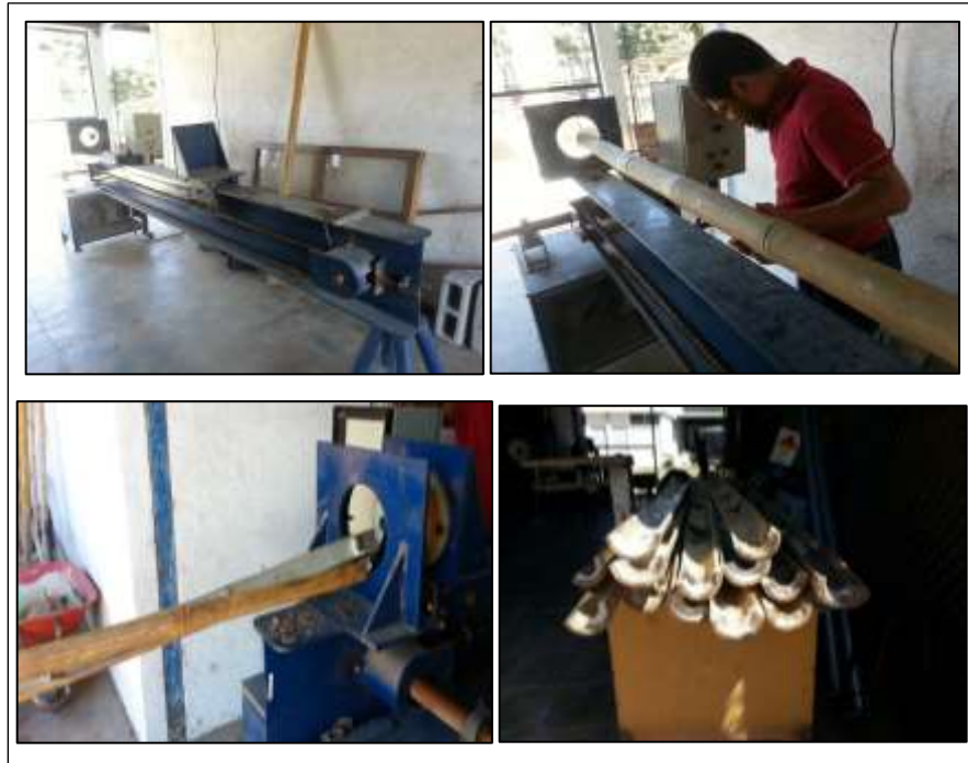
Figura 27. Corte longitudinal del bambú
