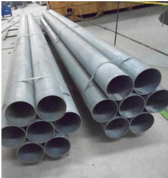
Figura 42. Tubería que se utilizará para sistema de enfriamiento
