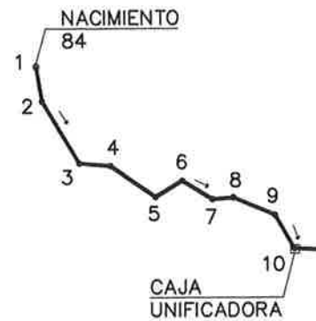
PLANTA LINEA DE CONDUCCION 1 A 10 ESCALA 1/2500
