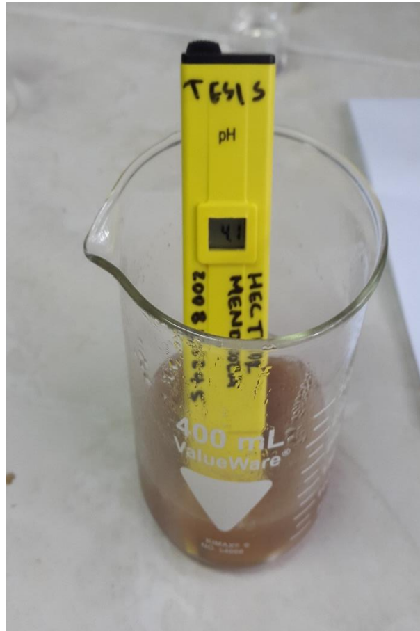
Imagen 7. Estabilización de la muestra con hidróxido de sodio 1N hasta llegar a un pH 4
