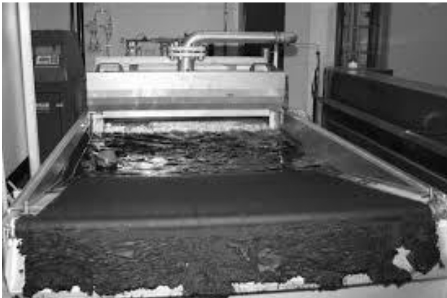
Figura 7. Filtración, filtro banda
