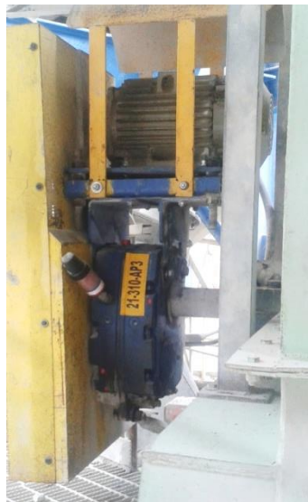
Figura 5. Montaje de motor, reductor y relación de poleas
