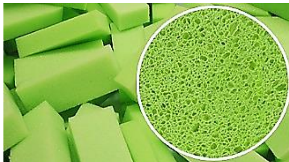
Figura 4. Vista microscópica de una esponja flexible de baja densidad
