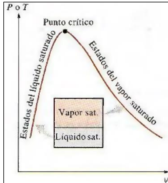
Figura 19. Diagrama de región de vapor saturado
