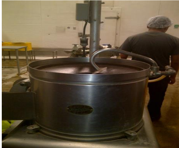
Figura 9. Estación de pelado
