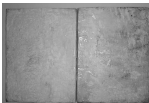
Figura 64. Teja plana de tetrabrik
