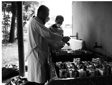
Figura 2. Proceso de lavado de envases de tetrabrik
