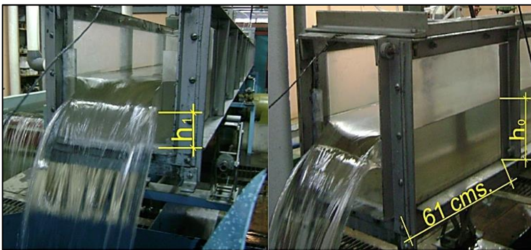
Figura 26. Vertedero rectangular en el laboratorio
